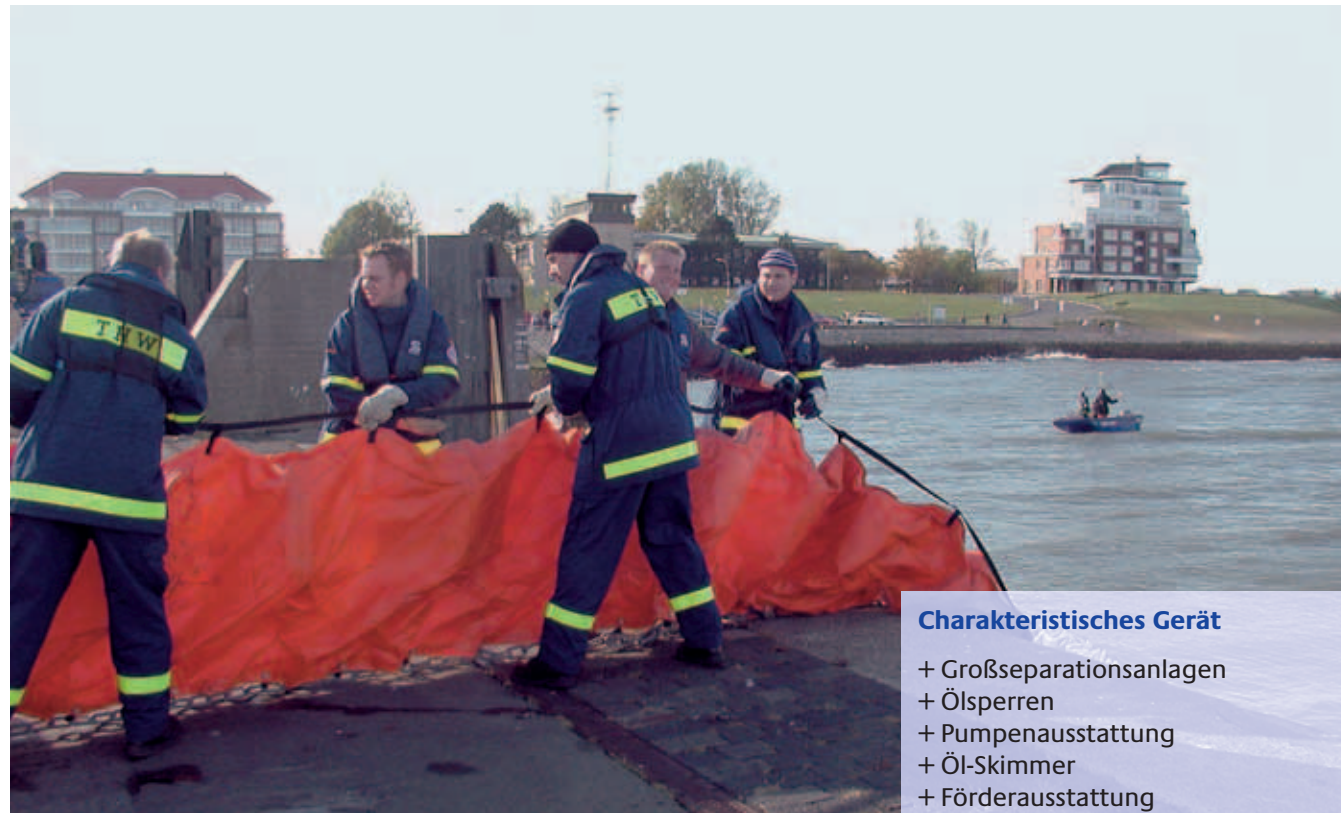
Mit Ölsperren kann verschmutztes Wasser eingedämmt werden.
